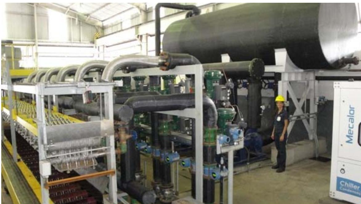
**Figura 2.** Visão geral do resfriamento acelerado piloto instalado no Centro de Tecnologia Usiminas – Usina de Ipatinga.
