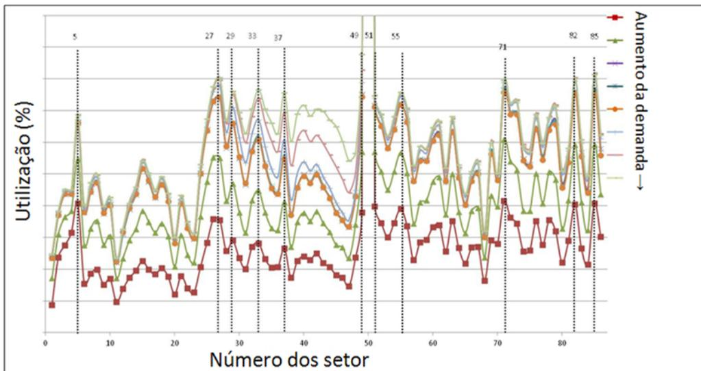
Figura 11 – Utilização dos setores.  $\text{Setor } [(trecho\ i) + ((nó\ i\ na\ direção\ porto) + (nó\ i+1\ na\ direção\ mina)) / 2]$
