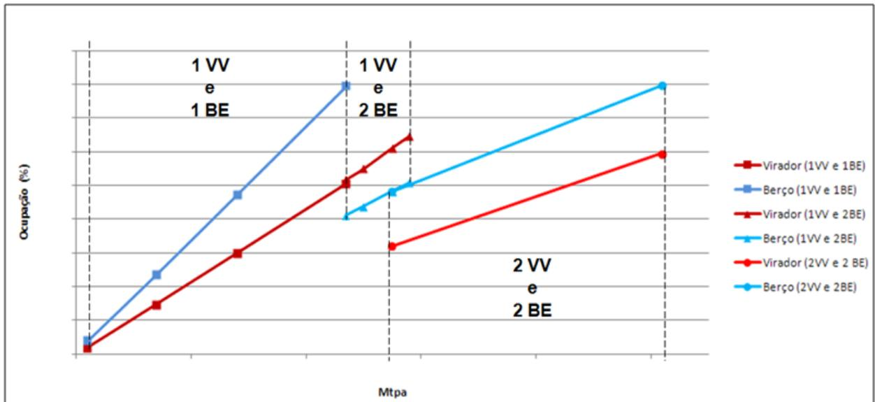
Figura 13 – Utilização do Virador de Vagões e do Berço, para frota determinada.
