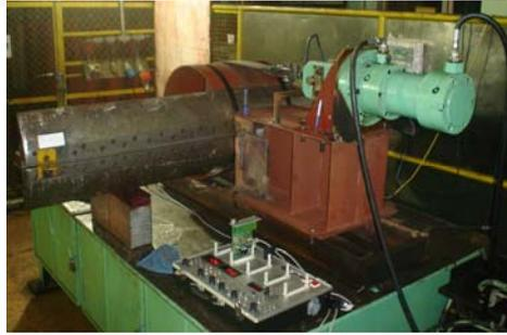
Figura 11. Dispositivo para medição de tração com arco de contato.
