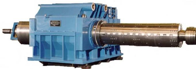
Figura 1. Bobinadeira de laminador Sendzimir.<sup>(3)</sup>
