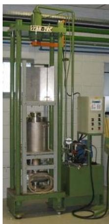
**Figura 3.** Forno a vácuo, do Grupo de Materiais (LNLS) com prensa acoplada para sinterização do composto Cu-Al<sub>2</sub>O<sub>3</sub>.
