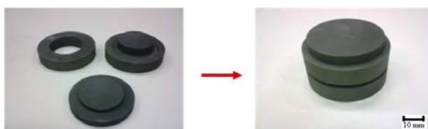
**Figura 2.** Dispositivo de grafite antes da montagem (*esq.*) e depois da montagem (*dir.*).
