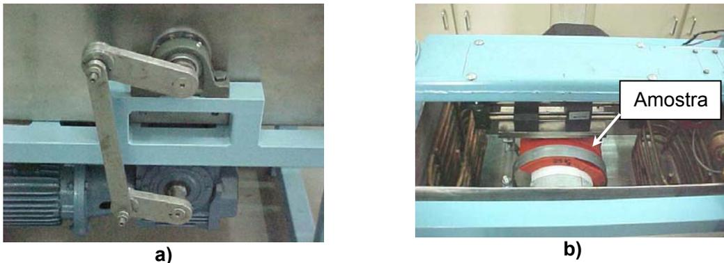
Essa taxa foi calculada através da divisão do volume retirado durante o ensaio (perda de massa [g] dividido pela densidade [ $\text{g}/\text{mm}^3$ ]) pelo comprimento total deslizado. Optou-se por esse cálculo para que o valor da taxa de desgaste seja específico e não esteja ligado diretamente ao diâmetro da calha. Esses valores estão expressos na Figura 6.
