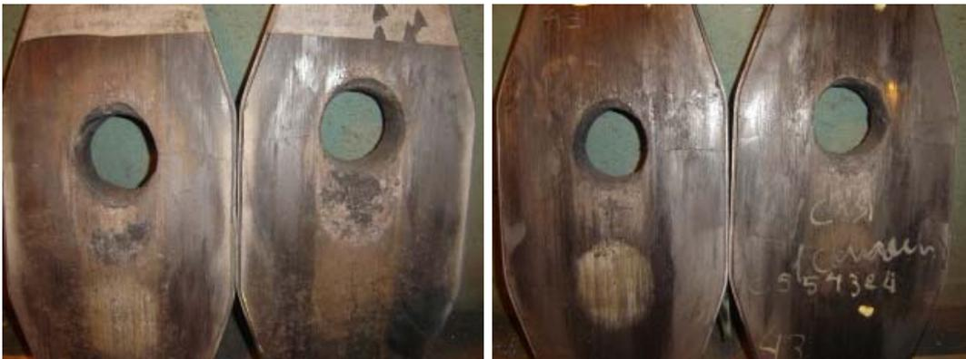
Figura 7. Placas de válvula Gaveta após redução da temperatura
