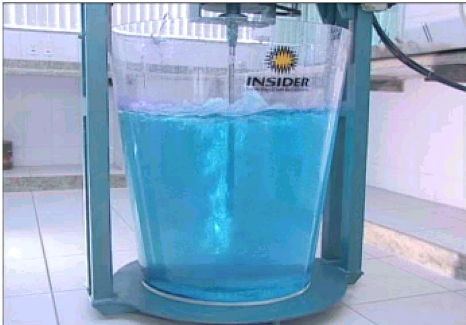
Figura 1 – Vaso com água e lança com furo vertical para simulação experimental.
