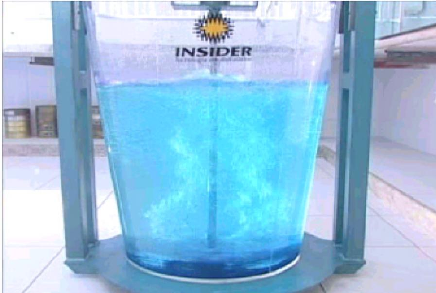
Figura 2 – Vaso contendo água e a lança com dois furos horizontais para simulação experimental.
