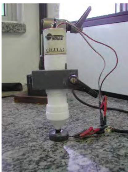
Figura 1. Célula de ensaio EPR de campo.
