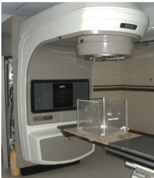
**Figura 1.** Acelerador linear Varian Clinac 600C utilizado em tratamentos de radioterapia e disponível no Hospital do Câncer de Muriaé (Fundação Cristiano Varella), em Minas Gerais. A irradiação das ampolas foi realizada dentro da caixa de acrílico mostrada no centro do equipamento.
