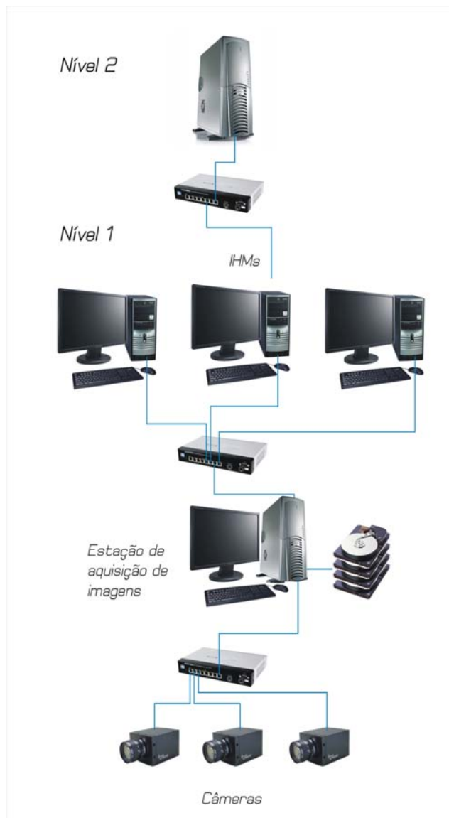
Figura 5: Arquitetura do sistema de identificação de particulado.
