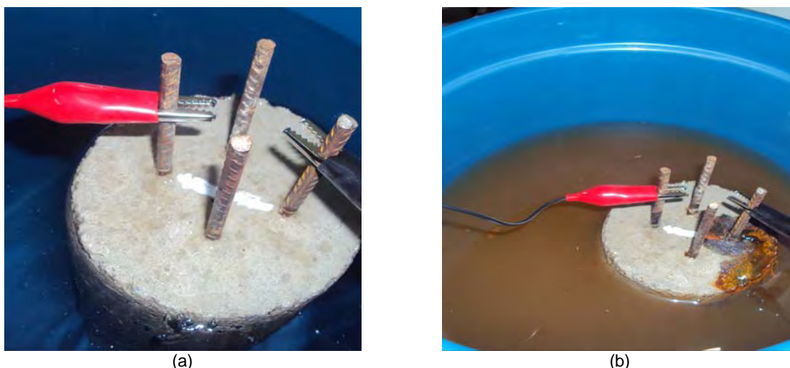
Figura 2. (a) Amostra submetida a voltagem e (b) Amostra após 24 horas de ensaio.
