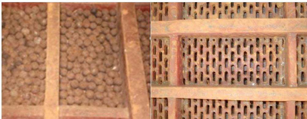
Figura 3 – Leito artificial constituído de esferas de aço e crivo de suporte do leito da jigagem de Brucutu (Fonte: Arquivo de fotos da jigagem de Brucutu).
