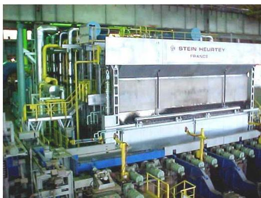
**Figura 1.** Forno de reaquecimento de perfis da Gerdau Ouro Branco.
