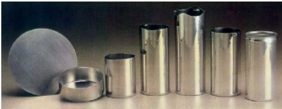
Figura 6: Representa a seqüência de etapas de produtos na Estampagem das latas de alumínio até a obtenção da latinha sem pintura.
