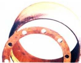
Figura 11. Tambor com fratura no flange de aparafusamento[2].
