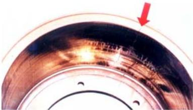
**Figura 1.** Trincas provenientes de fadiga<sup>[2]</sup>.
