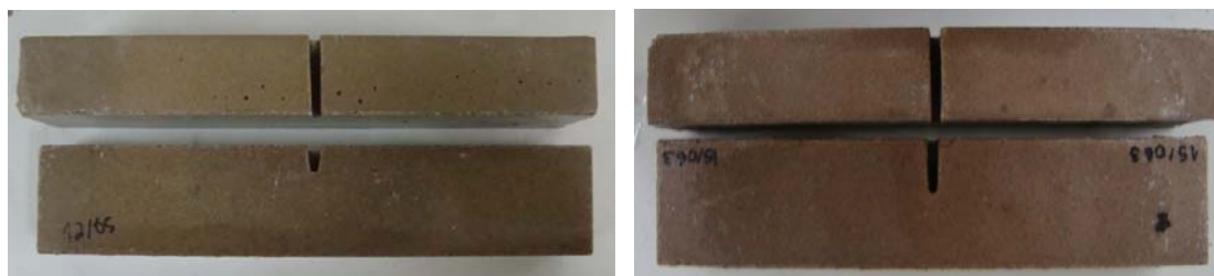
Figura 3. Corpos de prova com entalhe em “U” profundo.
