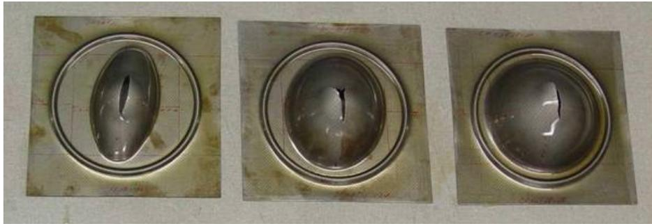
**Figura 4.** Foto dos *blanks* para ensaio *Bulge-Test*, depois de ensaiados.
