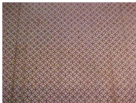
**Figura 3.** Foto mostrando a impressão da malha circular de 3,0 mm nos CP's confeccionados.
