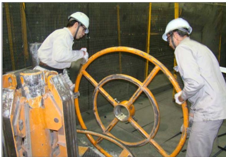
Figura 2: Perda de produtividade em função do elevado tempo gasto na execução da atividade de abastecimento dos desbobinadores.
