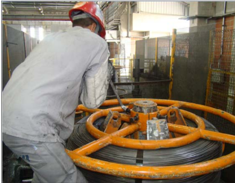
Figura 1: Risco de queda do operador da máquina durante o abastecimento do desbobinador.
