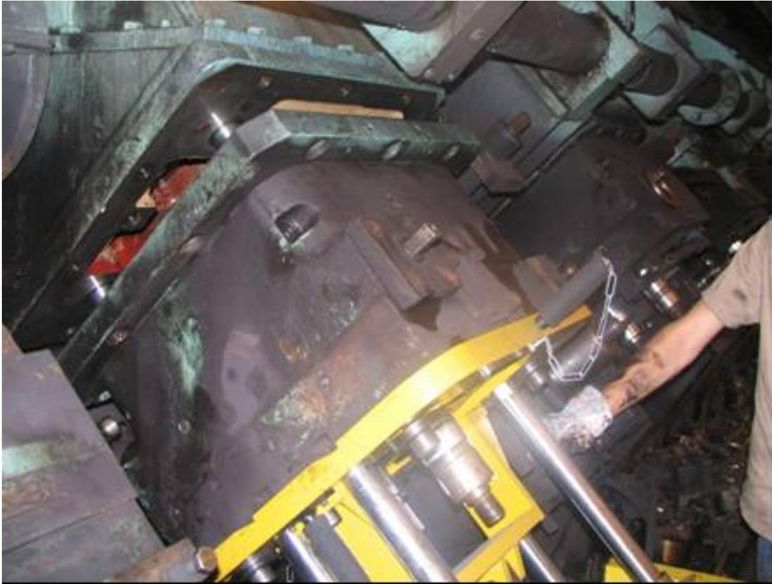
**Figura 4.** Gaiola sendo retirada pelo dispositivo hidráulico.
