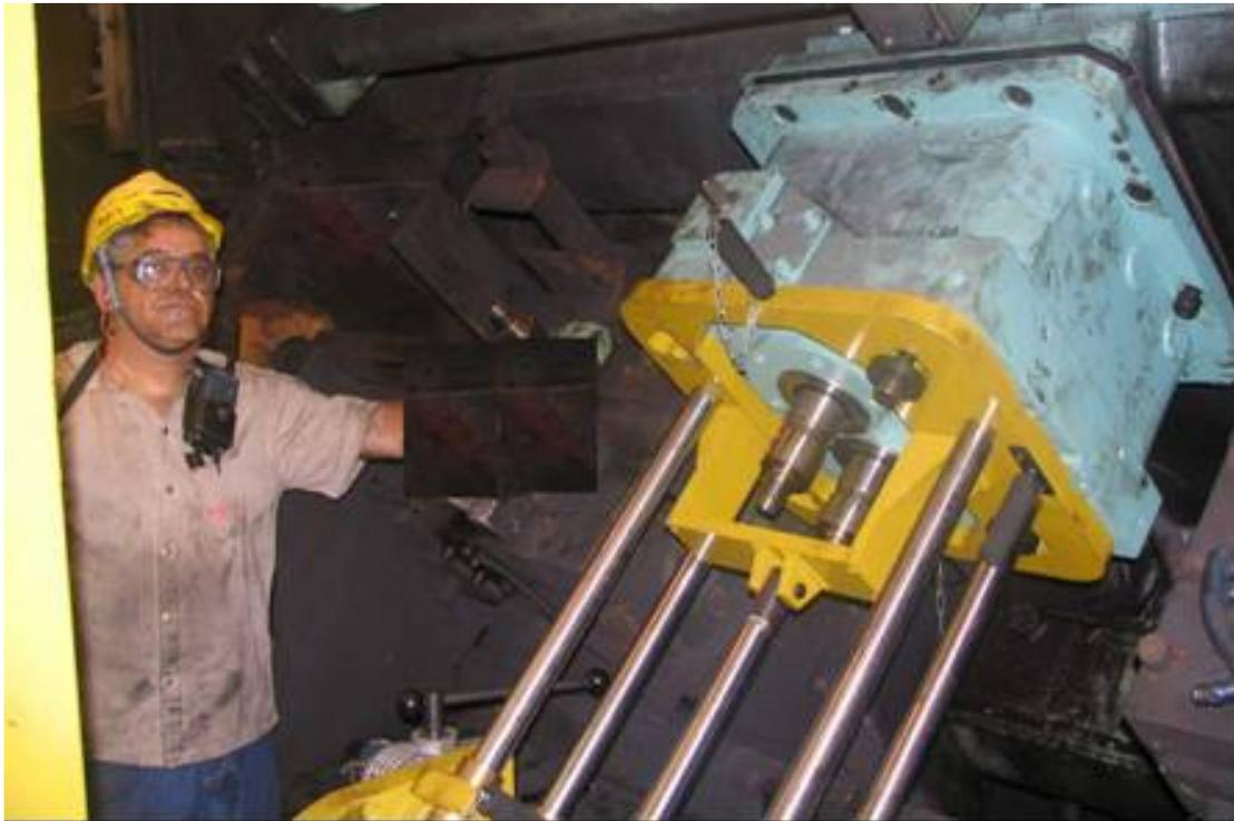
**Figura 5.** Gaiola nova sendo introduzida pelo dispositivo Hidráulico.
