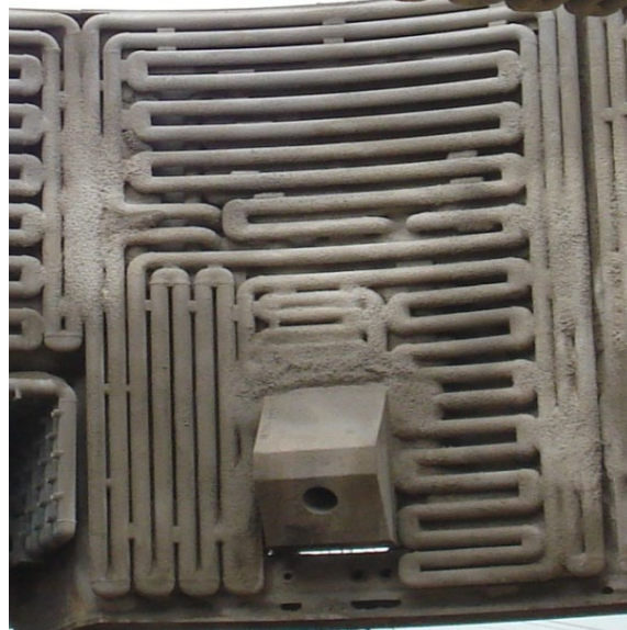
Figura 3: Painel refrigerado convencional da Pos 10.
