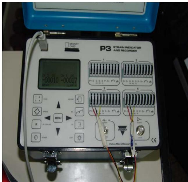
**Figura 4** – Dispositivo de condicionamento de sinal elétrico (P-3 da VISHAY).
