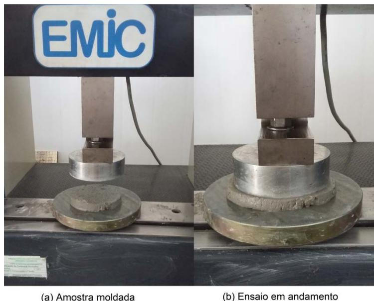
**Figura 3.** Amostra moldada e ensaio de *squeeze-flow* em andamento
