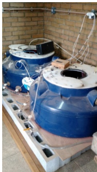
Figura2. Câmara de carbonatação utilizada na pesquisa.
