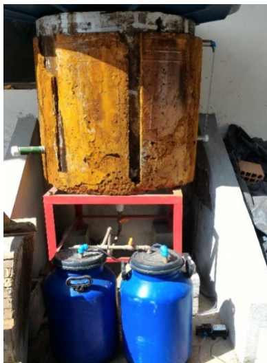
Figura3. Câmara de sulfatação utilizada na pesquisa.
