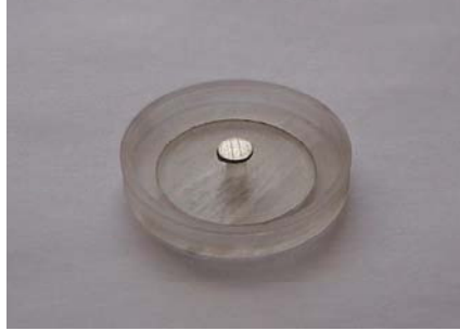
Figura 1. Porta amostra usado para a medição da fração volumétrica de martensita por difração de raios-X em pastilhas cortadas das paredes dos copos conformados.
