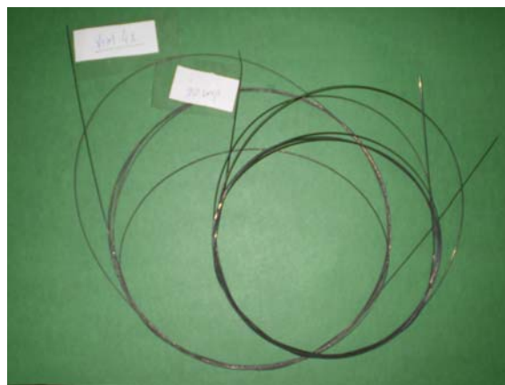
Figura 3: Fios de NiTi com 1,0 mm de diâmetro.
