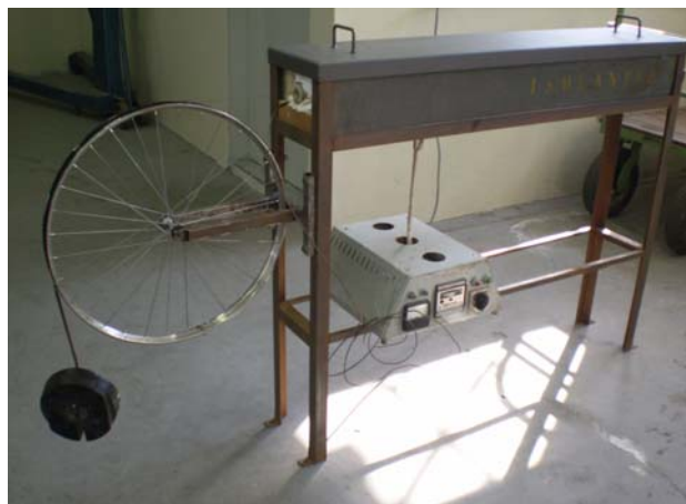
Figura 4: Forno tubular com dispositivo de tracionamento do fio para memorização de forma.
