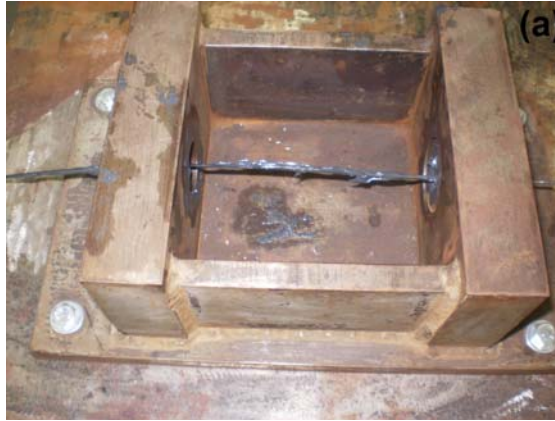
Figura 2: Porta feira com feira de metal duro, e montagem de fio lubrificado com bissulfeto de molibênio ( \text{MoS}_2 ).
