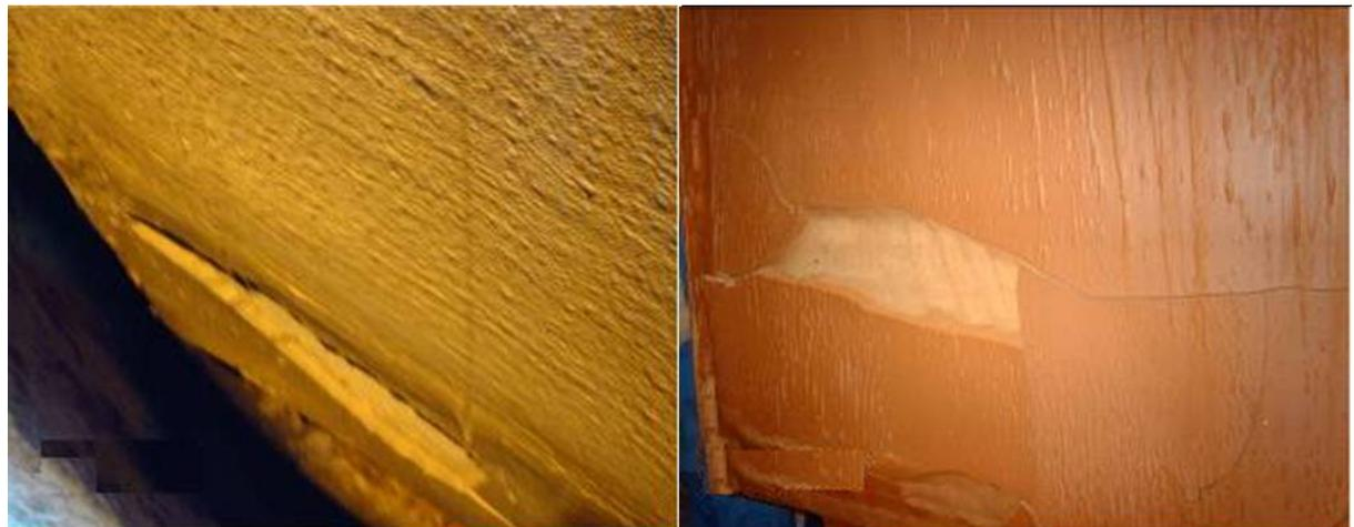
**Figura 19.** Crostas nos filtros na área da filtração de segurança.
