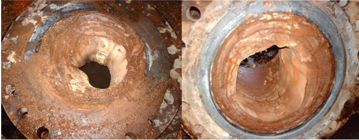
**Figura 17.** Crostas na tubulação dos reatores (autoclaves) das unidades de digestão.
