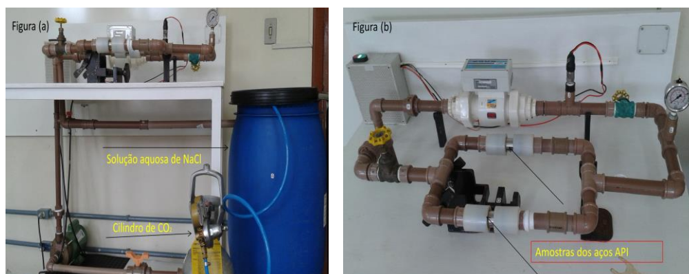
Figuras 1 - (a) e (b) - As figuras representam a vista frontal e superior do loop de bancada utilizada para simular o transporte do petróleo. Na figura (b) podemos observar os corpos de prova encaixados no loop.
