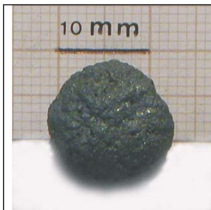
**Figura 4.** Pelota de minério de ferro e grafita, 7% em massa seca de cimento Portland tipo ARI, ciclo em etapas, 10 min a 1573 K, e 10 min a 1673 K.
