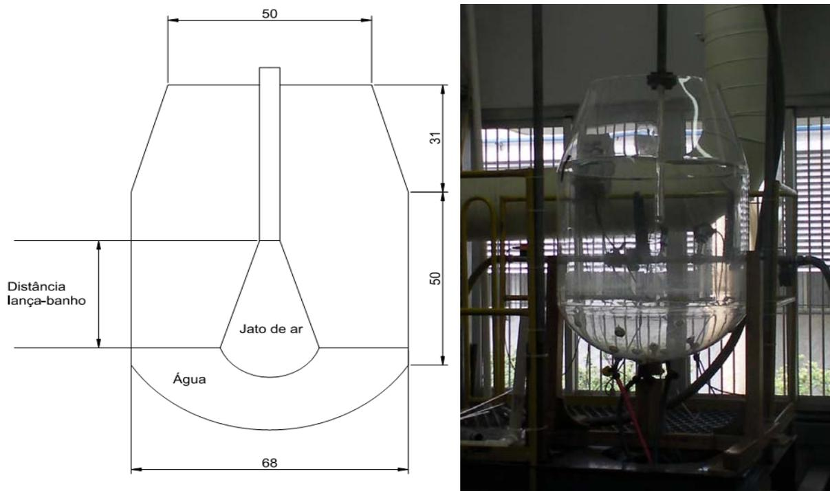
**Figura 3.** Dimensões do modelo físico do convertedor BOF.
