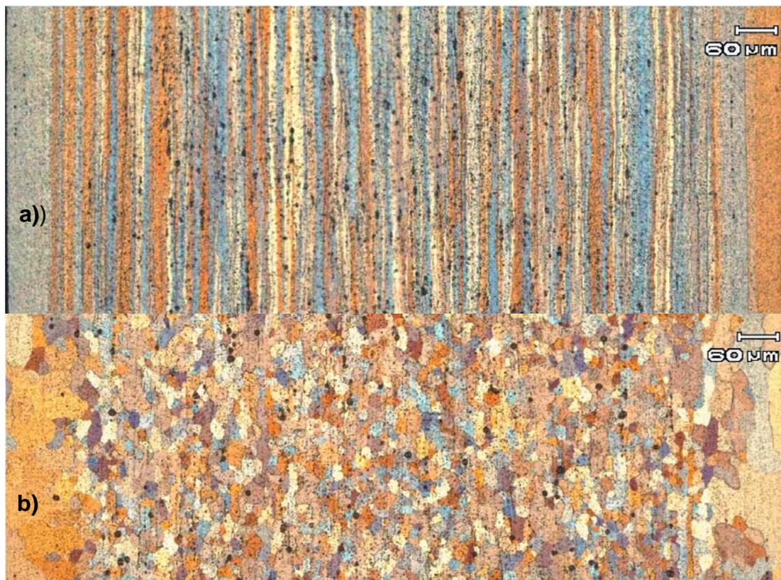
**Figura 4.** a) Microestrutura da amostra da liga 3104 sem recozimento com 100X; b) Microestrutura da amostra da liga 3104 com recozimento com 100X.
