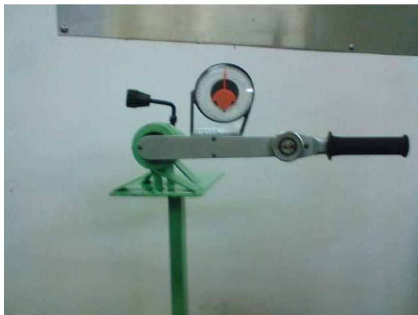
**Figura 2.** Máquina de deformação por torção.
