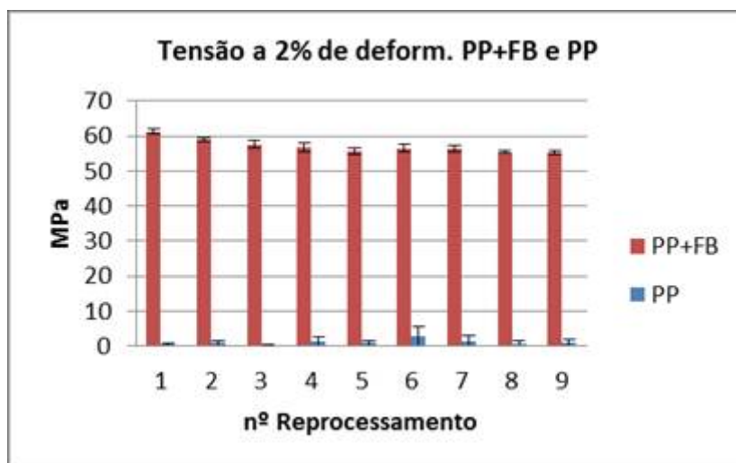
Figura 4. Resistência à flexão do PP virgem e do compósito de PP reforçado com fibra de bambu em função do número de reprocessamentos.
