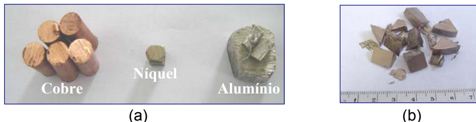
Figura 1. (a) Forma dos materiais utilizados para a obtenção da liga Cu-Al-Ni no forno de indução, (b) Carga de 20g de liga Cu-Al-Ni obtida no forno de indução, para reprocessamento em forno a plasma.
