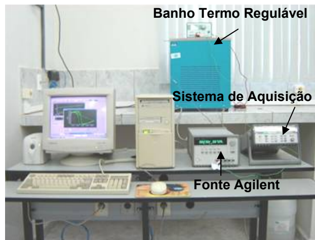
Figura 4. Bancada de teste para medição da variação de resistência elétrica em função da temperatura nas LMF.
