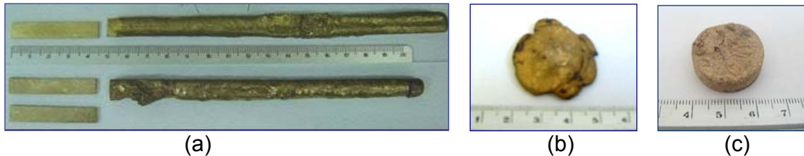
Figura 3. (a) Lâminas confeccionadas na Oficina Mecânica do DEM/CCT/UFMG a partir dos lingotes obtidos no forno a indução (b) botão e (c) pastilha obtidos no forno a plasma.
