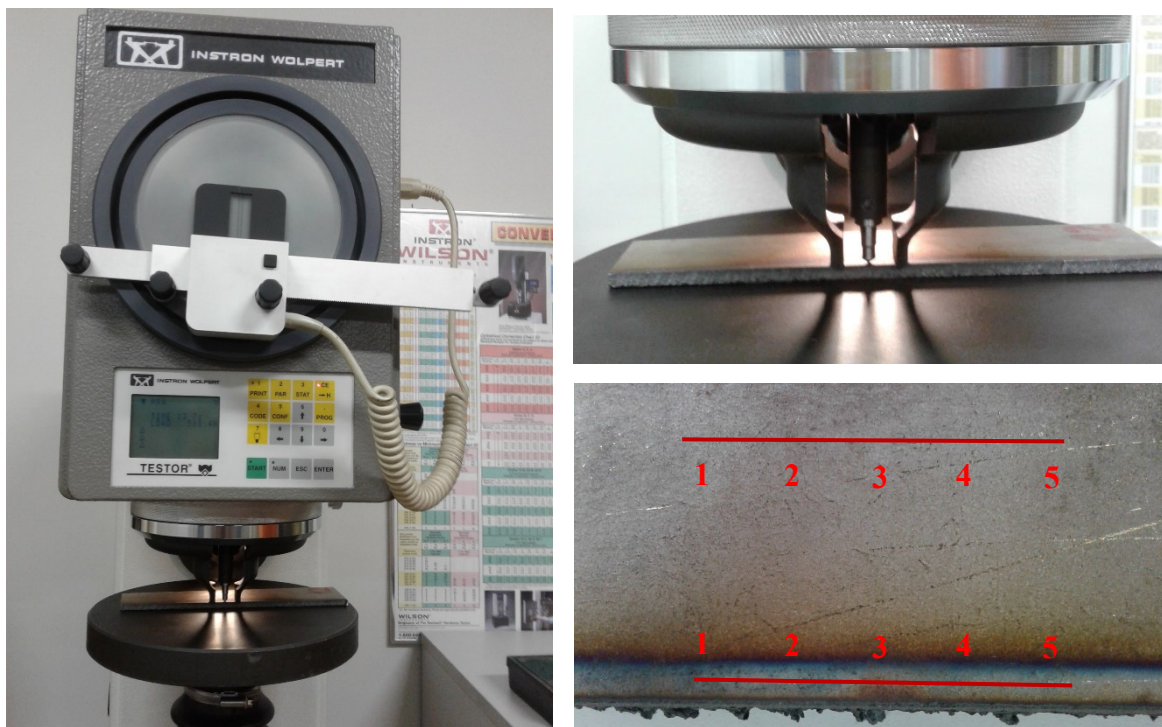
Figura 8. Ensaio de dureza Rockwell A.
