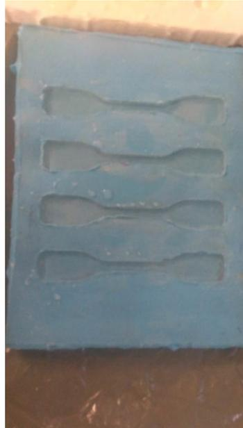
**Figura 2.** Matriz utilizada para a confecção dos corpos de prova.
