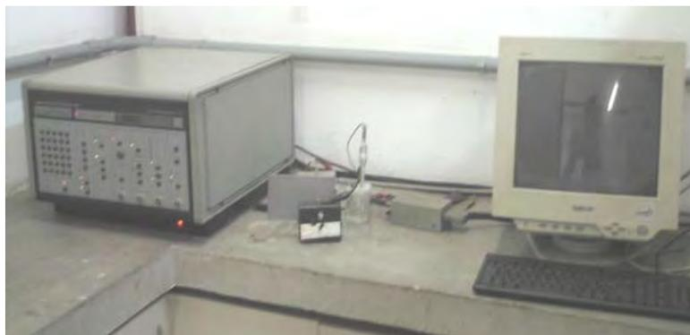
Figura 1 – Conjunto de equipamentos utilizados para a realização de ensaios de polarização.
