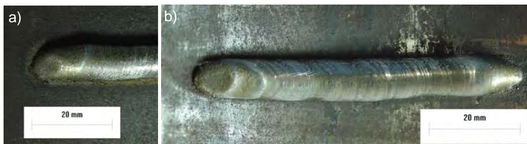
Figura 3. (a) Pós não fundidos no final do cordão de solda; (b) Vista superior do cordão soldado da condição 3 (VGPR – 10 l/min, mistura de argônio e hélio, VGP – 5 l/min e DBP – 16 mm).
