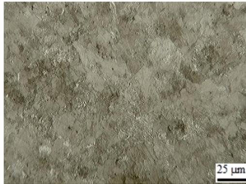
**Figura 06.** Micrografias do corpo de prova apenas normalizado.
