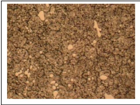
**Figura 7.** Microestrutura da amostra em aço D2 tratada pelo processo convencional
