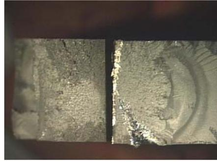
**Figura 6.** Fratografia de amostra de impacto em aço para trabalho a frio com 8%Cr tratada pelo processo Cryo® – 134,3 J
