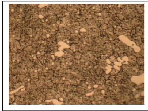
**Figura 8.** Microestrutura da amostra em aço D2 tratada pelo processo Cryo®
