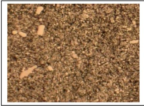
**Figura 11.** Microestrutura da amostra em aço para trabalho a frio com 8%Cr tratada pelo processo convencional
