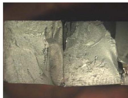
**Figura 4.** Fratografia de amostra de impacto em M2 tratada pelo processo Cryo® – 228,5 J
