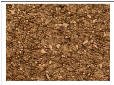
**Figura 9.** Microestrutura da amostra em aço M2 tratada pelo processo convencional
