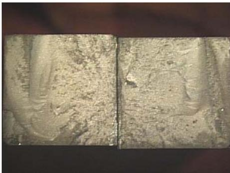
**Figura 1.** Fratografia de amostra de impacto em D2 tratada pelo processo convencional – 31,5 J
