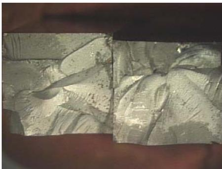
**Figura 3.** Fratografia de amostra de impacto em M2 tratada pelo processo convencional – 110,6 J
