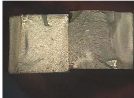
**Figura 2.** Fratografia de amostra de impacto em D2 tratada pelo processo Cryo® – 43,5 J
