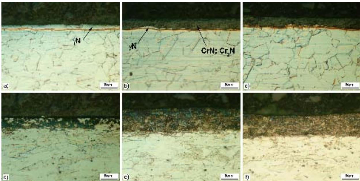
**Figure 1.** Optical cross section of nitrided samples: (a) AISI 316-450°C-400Pa; (b) AISI 316-500°C-400Pa; (c) AISI 316-500°C-600Pa; (d) AISI 409-450°C-400Pa; (e) AISI 409-500°C-400Pa; (f) 409-500°C-600Pa.
