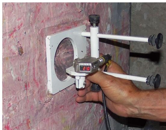
**Figura 3.** Medição da indentação com sensor laser.
