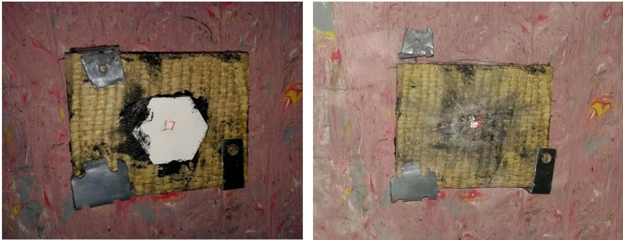
**Figura 4.** Sistema de blindagem multicamada (a) antes e (b) após o ensaio balístico.
