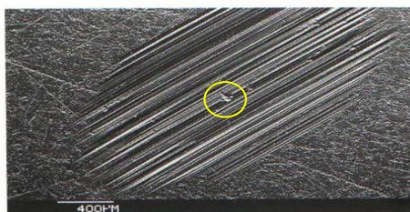
Ensayo SRV: calota de desgaste vista con gran aumento
