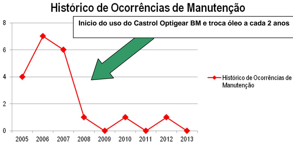
**Figura 18** - Demonstra o aumento da confiabilidade do equipamento após a aplicação do óleo lubrificante Optigear BM Castrol.
