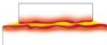
**Figura 4** - Etapa 3 Micro Flux Trans™ - Com a continuidade do movimento as superfícies são alisadas e durante o processo os picos são movimentados para preencher os vales. O contato real sobe para 80% reduzindo continuamente o atrito e temperatura.
