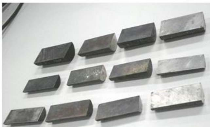
Figura 3. Representação das amostras de aço 1011, 1015 e 1048 após o corte.
