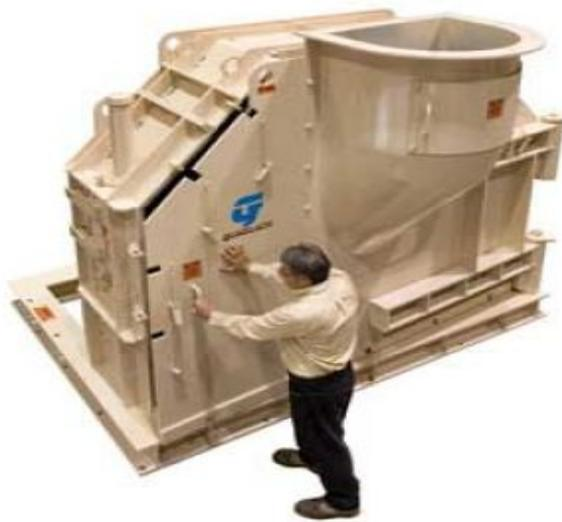
Figura 4. Britadores tipo gaiola utilizados na SunCoke Energy.<sup>(2)</sup>
