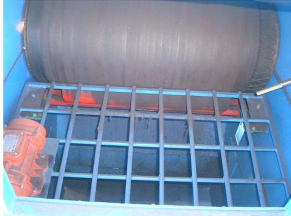
Figura 3. Modelo de grade utilizada para retenção de materiais posicionada antes dos britadores.
