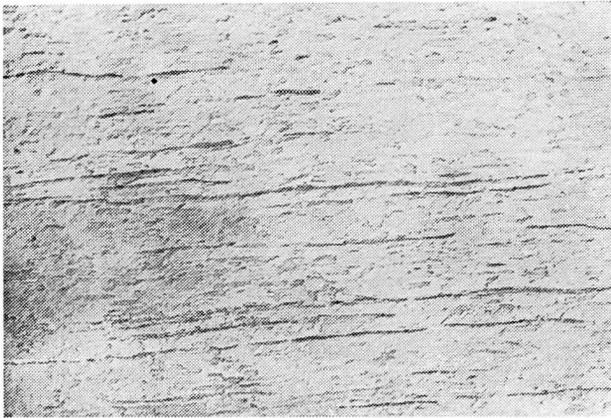
Fig. 5 — A pureza dos aços, no que corresponde à inclusões de escórias, é melhor nos aços carbono SAE 1035, 1045, etc. 100 ×.
