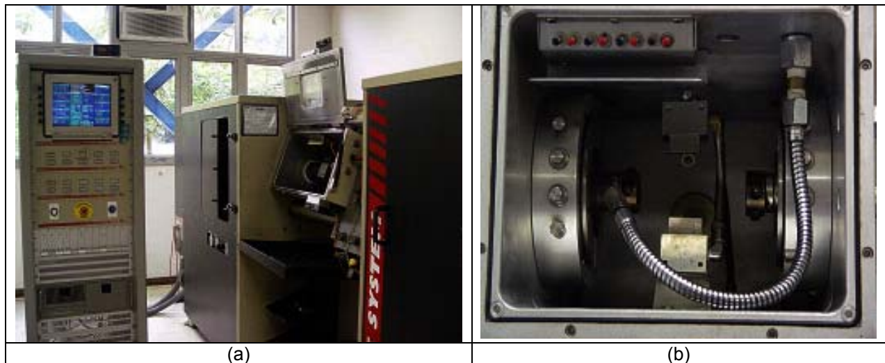
Figura 1. Simulador termomecânico Gleeble modelo 3500. (a) Aspecto geral do equipamento. (b) Câmara de ensaio de torção.
