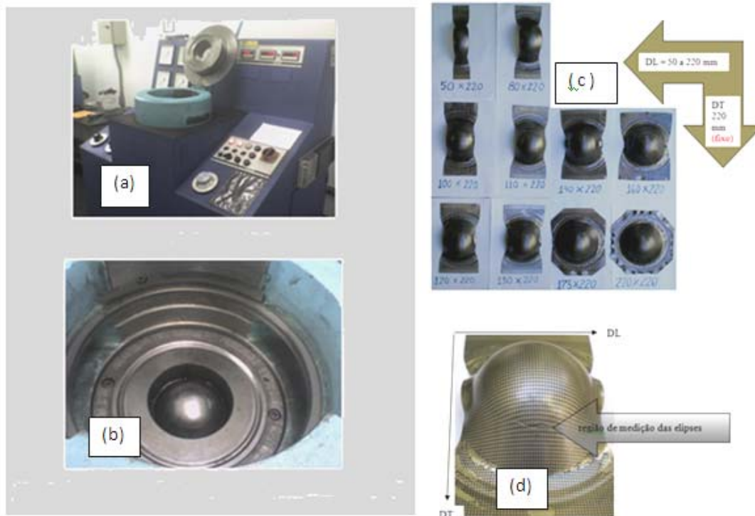
Figura 7 – (a) prensa Erichsen; (b) câmara de ensaio; (c) amostras tipo Nakazima; (d) região de medição das elipses. (26,27)
