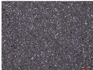
Figura 34: Fotomicrografia Visão geral, Luz refletida, nicóis paralelos, objetiva 4X (500µm).
