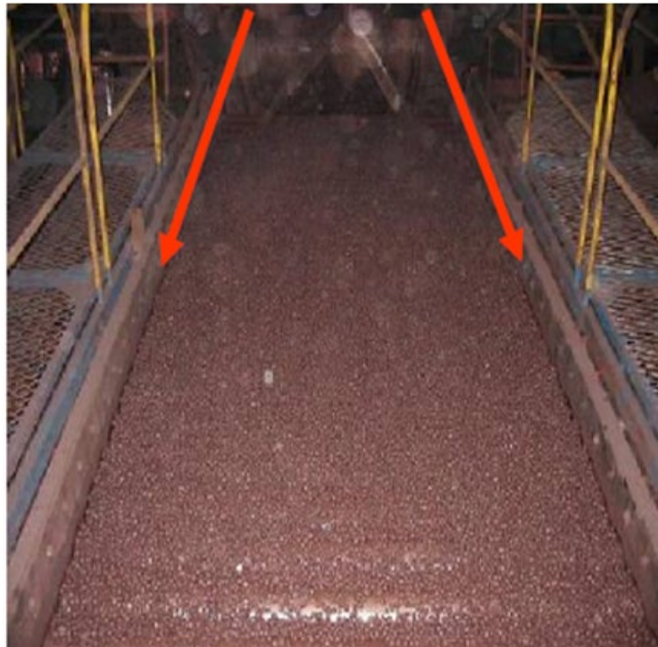
Figura 5. Classificação das pelotas através de peneira de rolos
