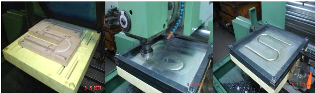
Figura 5: Etapas práticas do processo de Estampagem Incremental.
